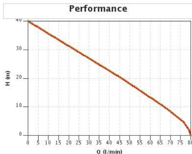
caractéristiques se référant à un fonctionnement avec de l'eau à 20°C
