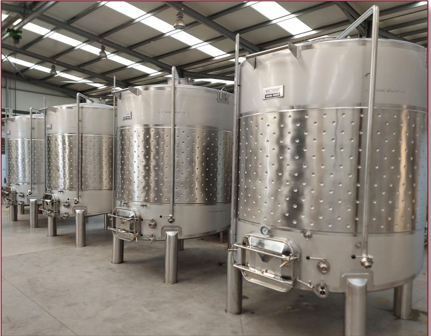
Notre cuve fermée et à fond plat incliné est généralement utilisée pour le stockage et la vinification de vin rouge et de blanc mais peut aussi être utilisée pour d'autres productions de boissons.
